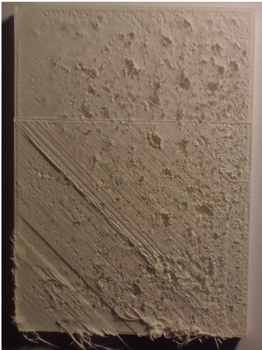
Slika 16: Nepravilno natisnjen pokrov, spodnja stran, lastna slika
