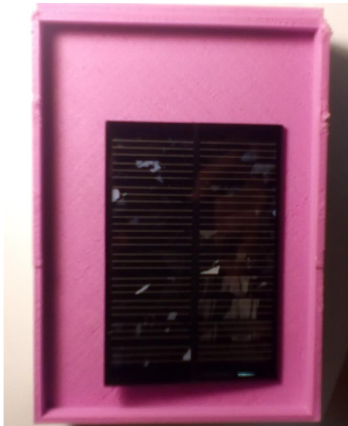
Slika 27: Montaža fotonapetostna modula na pokrov prenosne baterije, lastna slika
