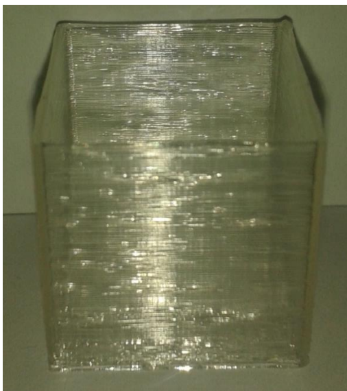
Slika 37: Izdelek z nepravilnostmi na stranicah zaradi neprimerne temperature pri 3D-tiskanju, lasten vir
