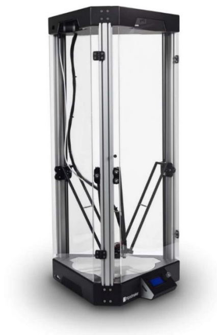
Slika 2: Primer izvedbe delta 3D-tiskalnika znamke Tripodmaker, vir [2]
