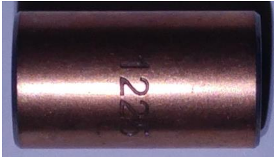
Slika 28: Samomazalna medeninasta puša, lasten vir
