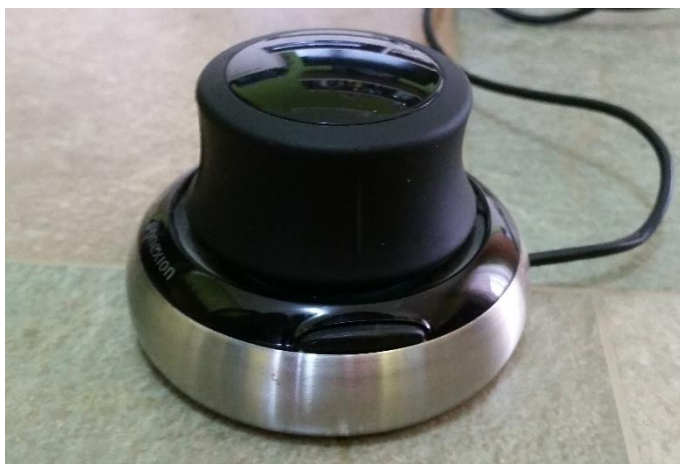
Slika 12: 3D-miška, proizvajalca 3Dconnexion, vir: lasten
