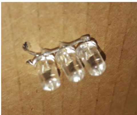
Slika 25: Slika LED-diod, kot svetilka za prenos podatkov, lasten vir
