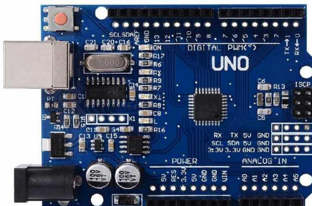
Slika 32: Mikrokrmilnik Arduino Uno, vir [5]
