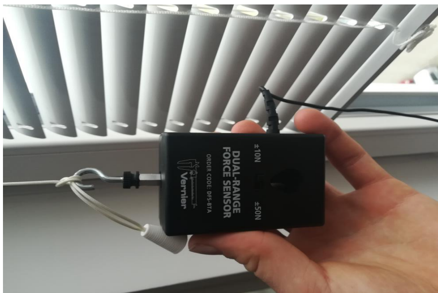
Slika 12: Merjenje sile z elektronskim silomerom VERNIER, foto: (A. Poklič)
