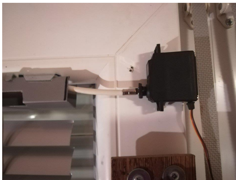
Slika 21: Rešitev zakrivanja/odkrivanja z motorčkom 1, foto: (A. Poklič)
