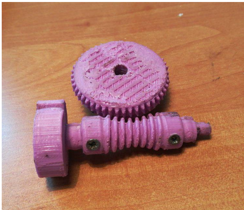
Slika 29: Natisnjena plastična dela (polž in zobnik brez koluta), foto: (A. Poklič)
