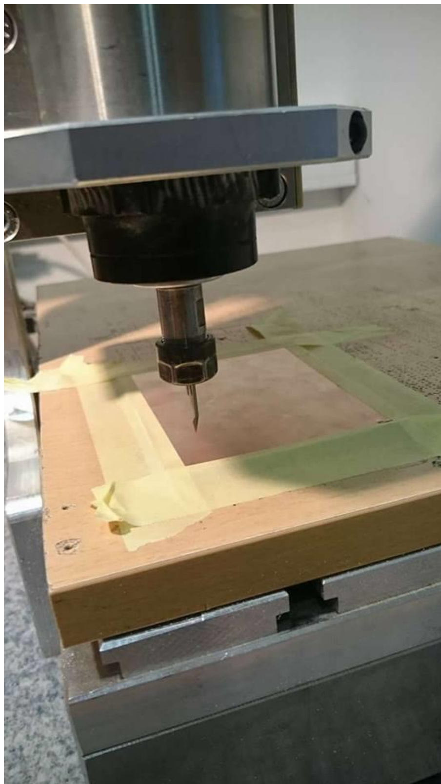
Slika 33: Rezkalna glava, na podlago prilepljena prazna bakrena plošča, foto: (B. Senič)
