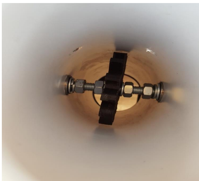
Slika 49: Vstavitev turbine v cev
