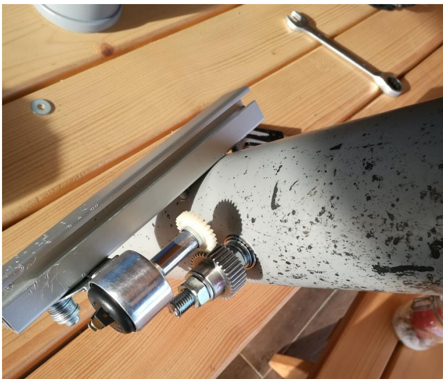
Slika 52: Montaža nosilca z dinamom
