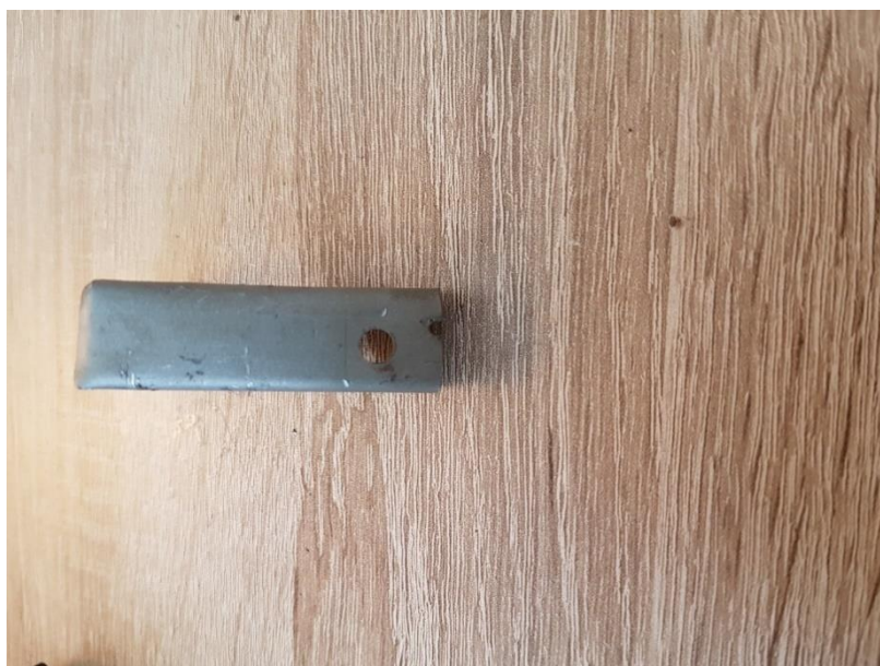
Slika 61: izdelan nosilec na generator
