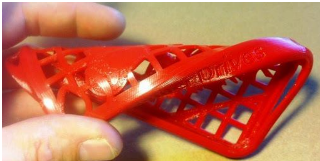
Slika 20: Elastično plastična nit (Ninja filament), vir: [9. sl.]
