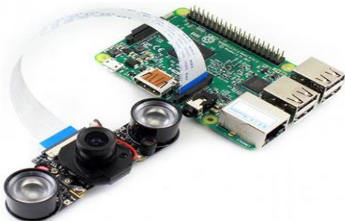
Slika 27: Kamera za Rasberry pi 3, vir [14. sl.]
