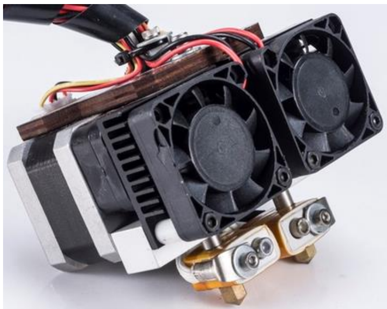
Slika 4: Tiskalna glava s dvema šobama (angl. ekstruder) stroja Formaker, vir: [2. sl.]
