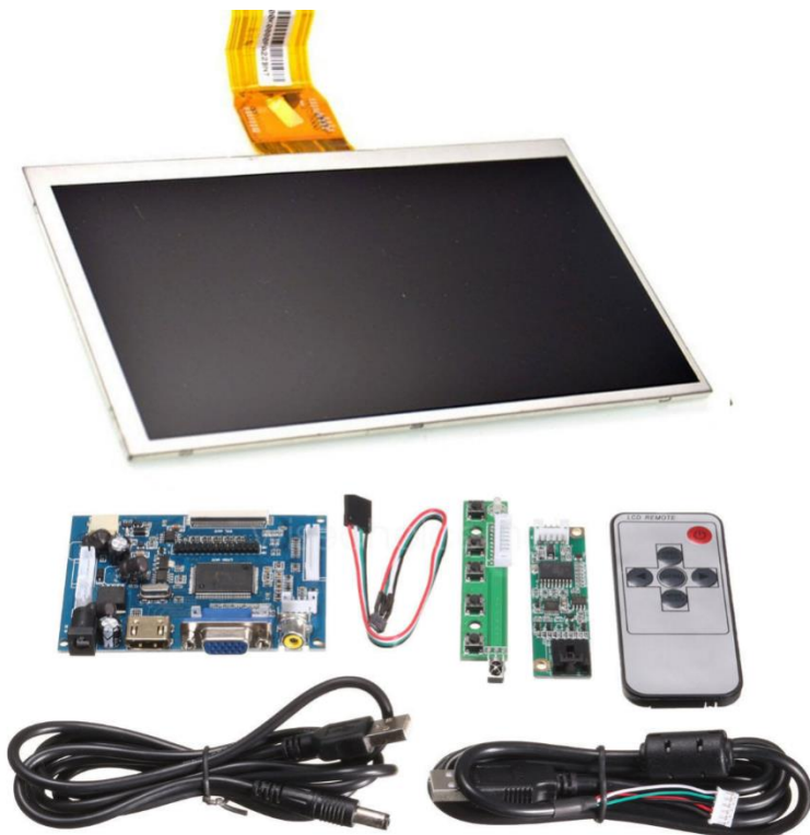
Slika 28: Komplet komponent barvnega LCD-zaslona na dotik za Raspberry PI 3 model B, vir [14]
