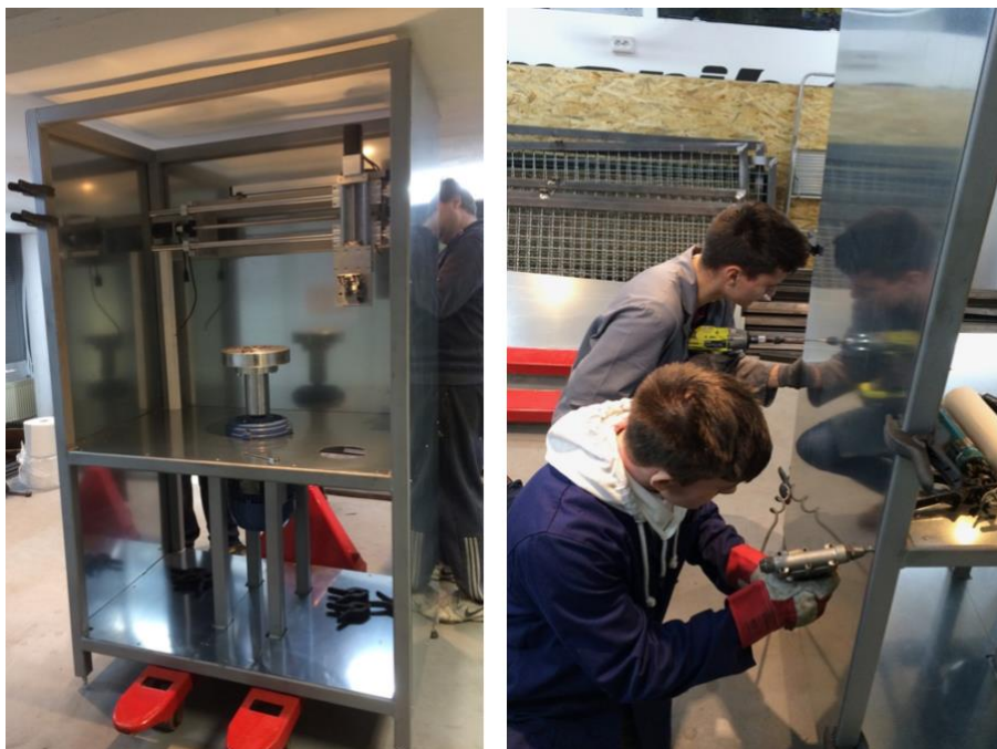
Slika 29: Pritrjevanje pločevine na ogrodje Vir [Lasten]
