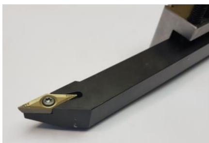
Slika 38: Stružni nož s karbidno ploščico Vir [Lasten]
