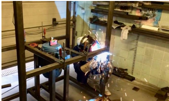
Slika 27: Varjenje ogrodja naprave z MIG postopkom Vir [Lasten]
