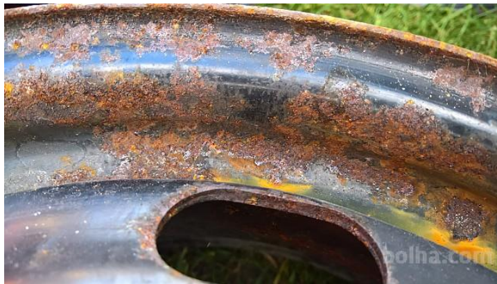
Slika 10: Poškodovano jekleno platišče Vir [6]
