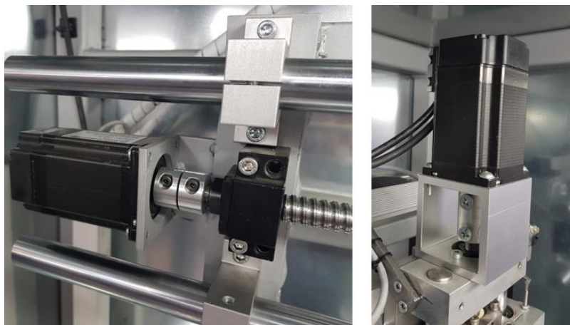
Slika 41: Koračna motorja vsakega izmed vodil Vir [Lasten]
