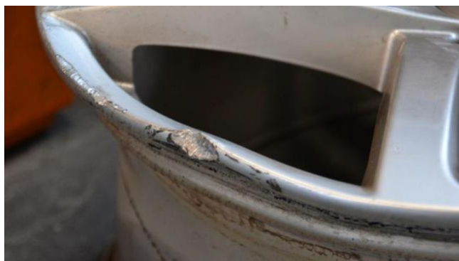
Slika 11: Poškodovano aluminijasto platišče Vir [7]
