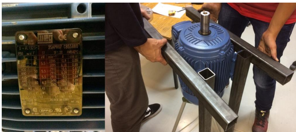
Slika 40: 3-fazni elektromotor in napisna ploščica Vir [Lasten]
