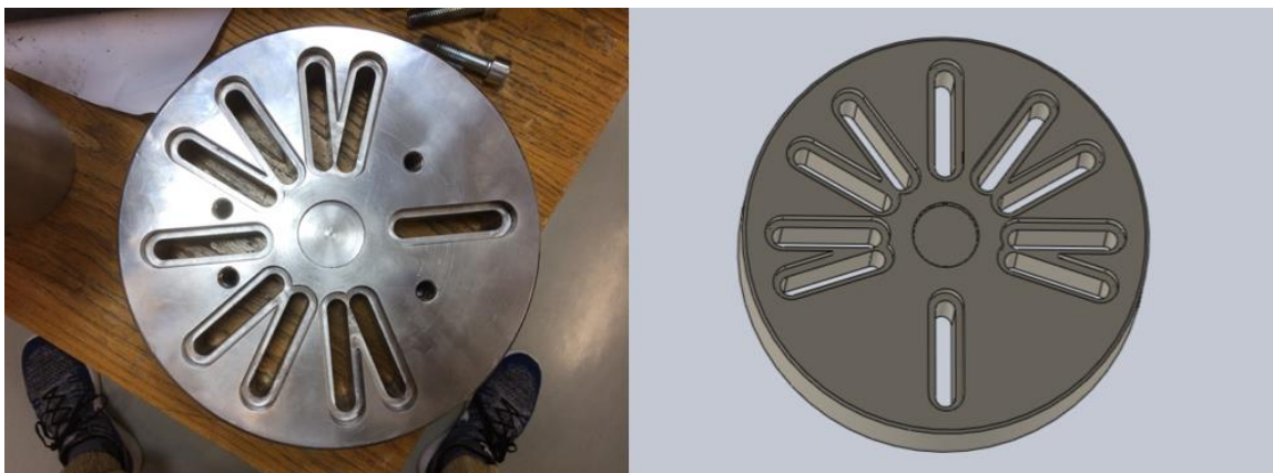
Slika 30: 3D model stružne glave in končen produkt Vir [Lasten]
