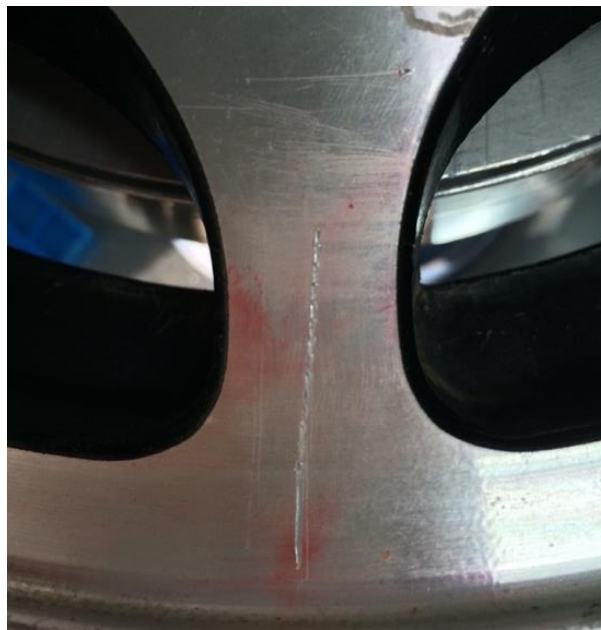
Slika 64: Poskus branja oblike in sledenja noža po njej Vir [Lasten]
