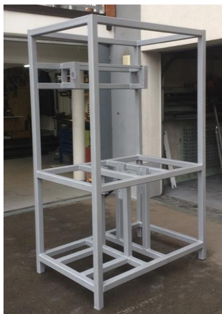
Slika 28: Prebarvano ogradje s prašno barvo Vir [Lasten]
