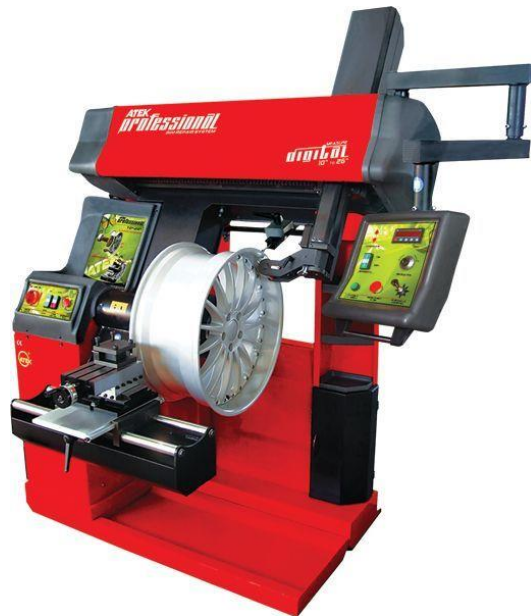
Slika 13: Naprava za ravnanje platišč Vir [9]
