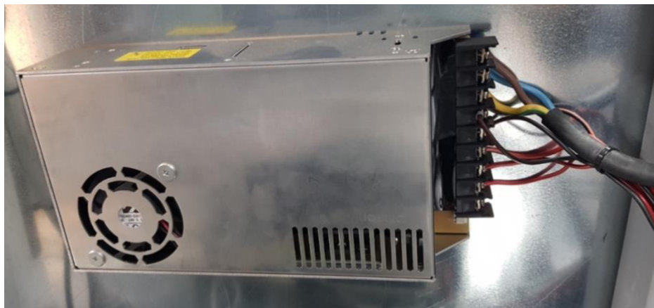
Slika 44: Napajalnik z izhodno napetostjo 36V DC Vir [Lasten]
