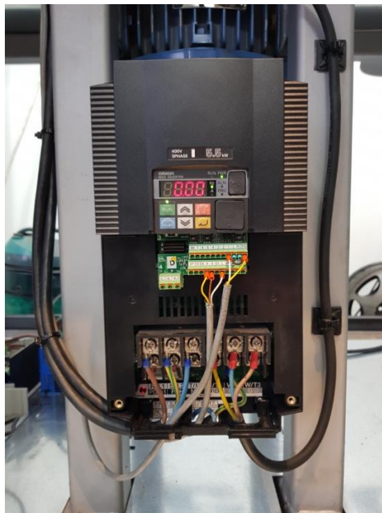
Slika 43: OMRON frekvenčni pretvornik Vir [Lasten]
