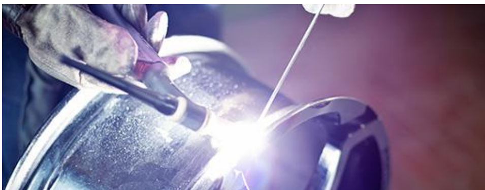
Slika 14: Varjenje ALU platišča s postopkom TIG Vir [9]
