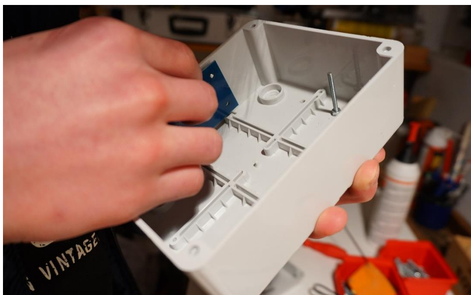
Slika 45: Pritrjevanje RFID senzorja (Foto: P. Vrčkovnik, 2018)
