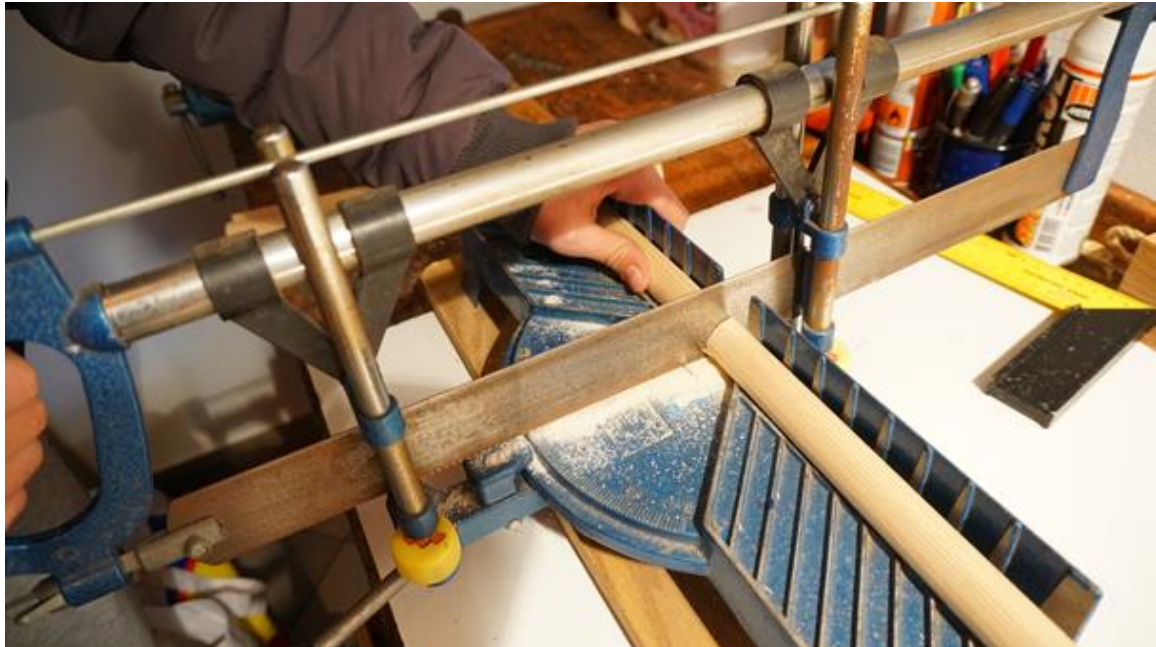
Slika 38: Rezanje letve za ogrodje (Foto: P. Vrčkovnik, 2018)
