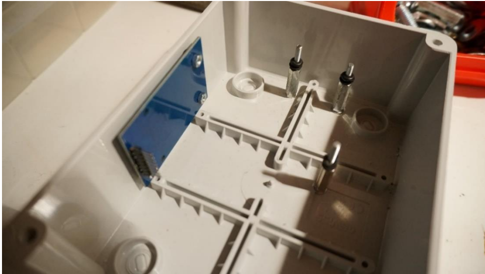
Slika 46: Pritrjen RFID senzor (Foto: P. Vrčkovnik, 2018)
