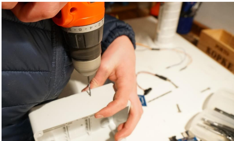
Slika 44: Vrtanje lukenj v ohišje (Foto: P. Vrčkovnik, 2018)
