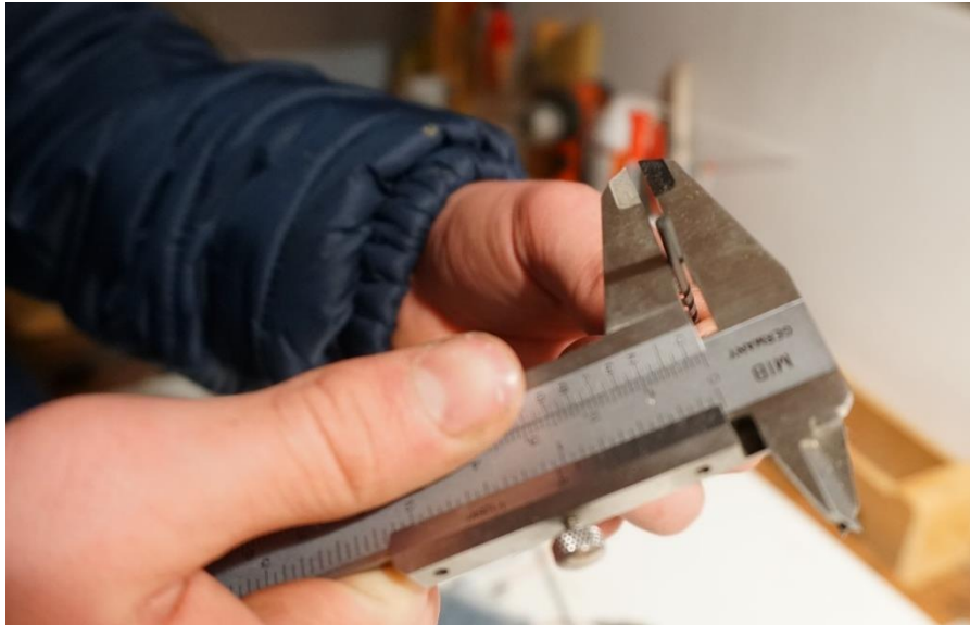
Slika 43: Merjenje širine oporne navojne palice (Foto: P. Vrčkovnik, 2018)
