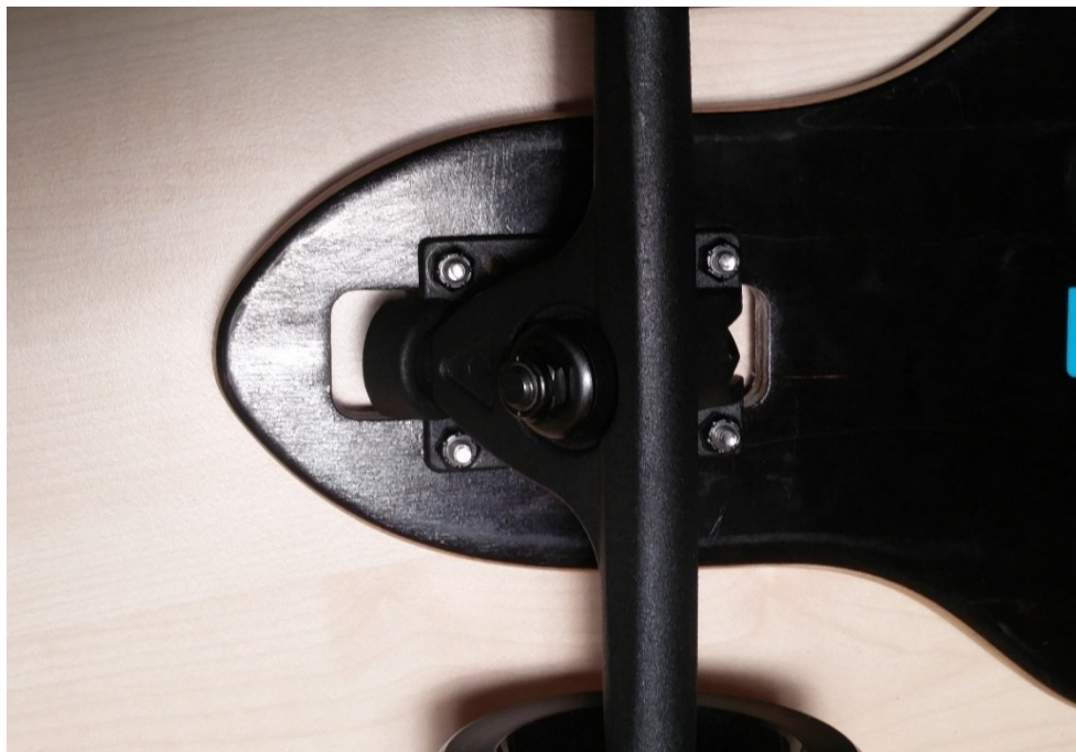
Slika 16: Pritrditev koles na desko (Foto: D. Čebular)
