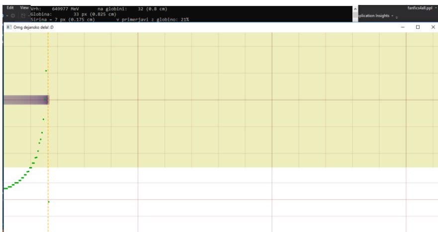
Slika 15: Doseg snopa protonov v volframu (na grafu za absorbirano energijo je prva odebeljena črta na vrednosti 100\,000\text{ MeV} / 0,25\text{ mm}^2 )
