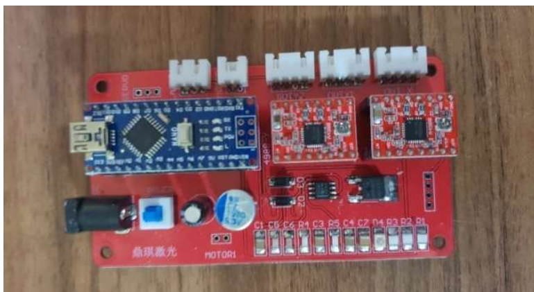
Slika 11: Arduino nano nameščen na kontrolno ploščo GRBL
