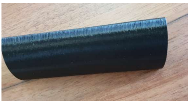
Slika 27: Tridimenzionalno natisnjena noga dolžine 120 mm
