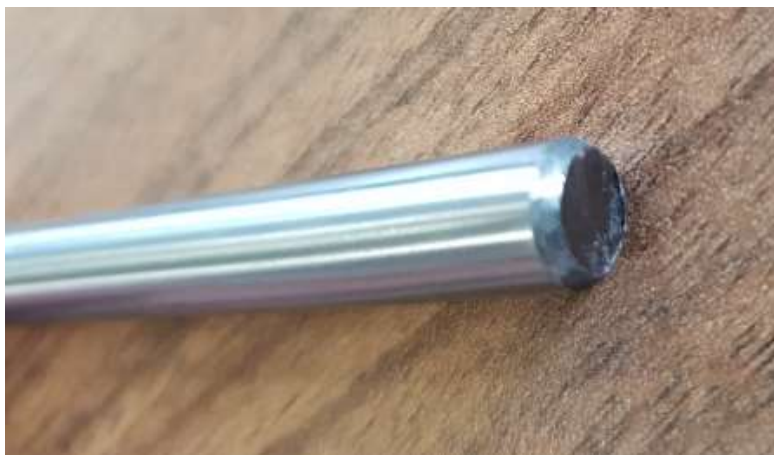
Slika 24: Vodilo premera 8 mm in dolžine 420 mm
