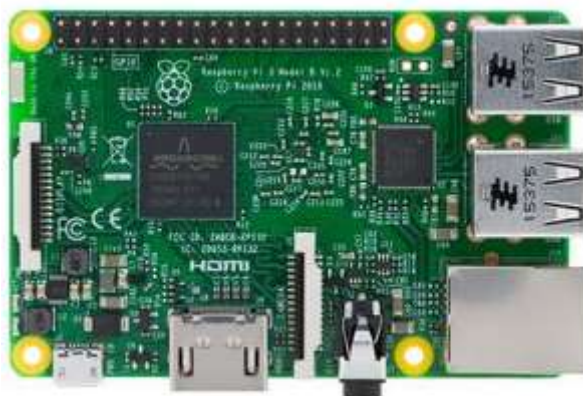
Slika 15: Na sliki vidimo Raspberry Pi 3-model b+, vir[13].
