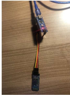
Slika 14: Priključitev HC-05 na Arduino Nano (Foto: P. Vrčkovnik, 2018)
