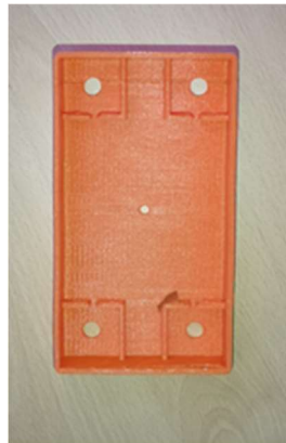
Slika 19: Notranjost ohišja prototipa (Foto: Miha Ogrizek, 2019)
