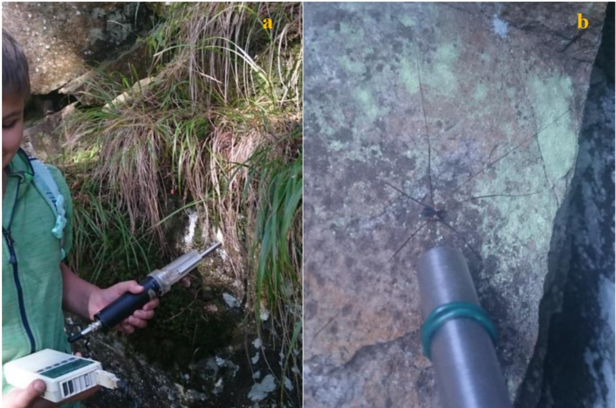
Slika 11: (a) Merjenje temperature zraka in zračne vlage s psihrometrom. (b) Merili smo v oddaljenosti 1 cm od skale. (foto: S. Lipovšek)
