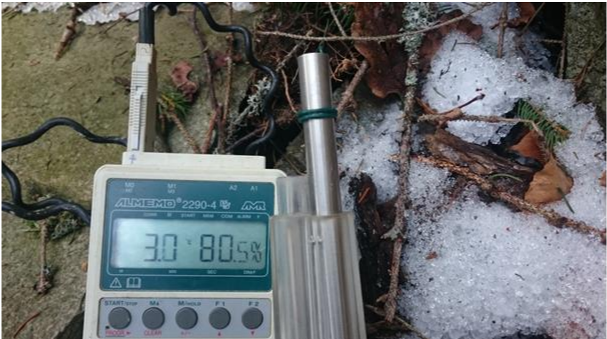
Slika 12: Merjenje temperature zraka in zračne vlage s psihrometrom (foto: M. Delakorda)
