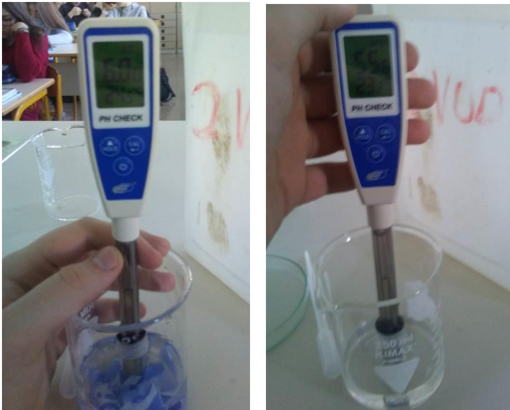
Slika 16: Merjenje pH z elektronskim pH metrom (levo voda z vrečkami s potiskom in desno brez potiska) (Foto: U. Sušec).
