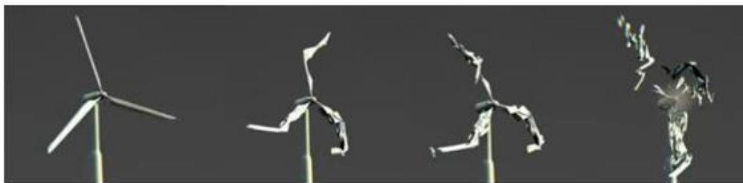
Slika 23: Razpad vetrne turbine pri visoki hitrosti (20).
