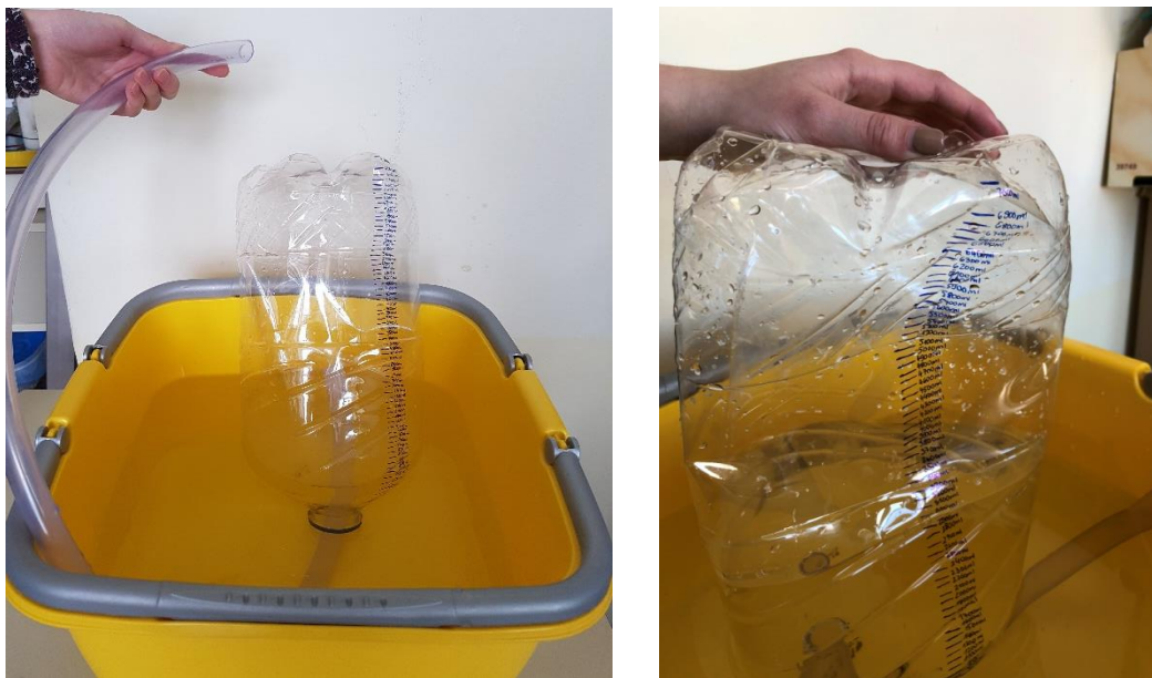
Slika 9: Spirometer 2 iz mehkejše plastike (Foto: S. Krajnc)
