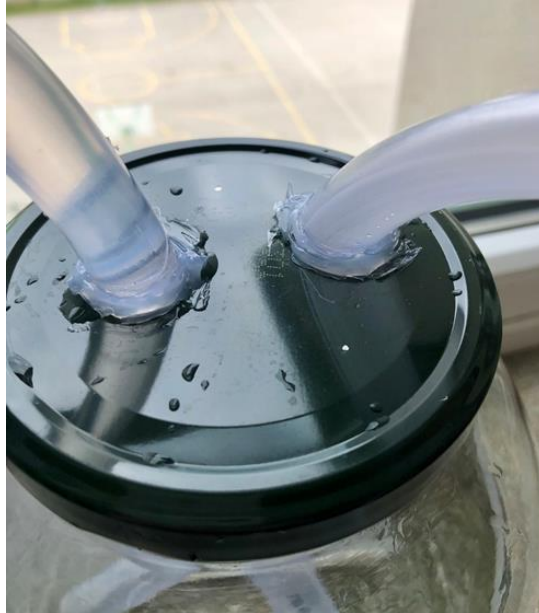
Slika 7: Cevki vstavljeni v kovinski pokrov, zalepljeni s silikonom (lepilna pištola) (Foto: S. Krajnc)
