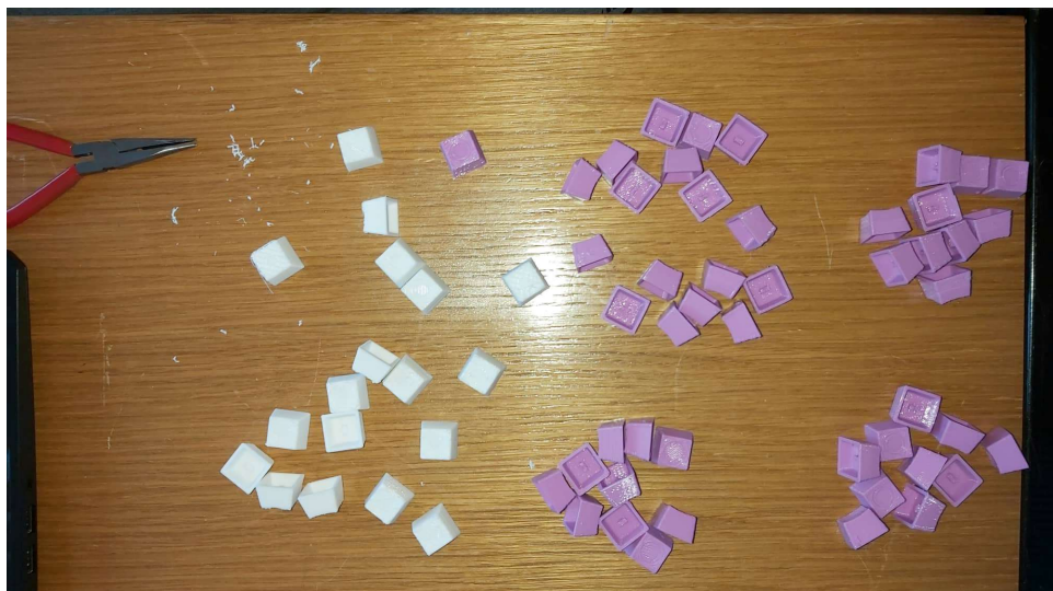
Slika 12: Prikazuje 3D tiskana stikala iz dveh različnih barv plastike
