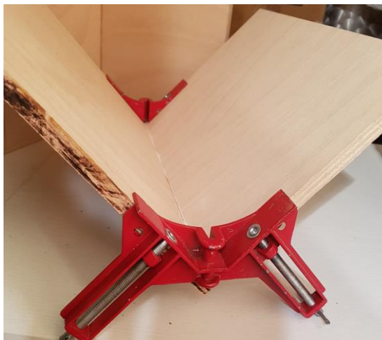
Slika 12: Princip lepljenja boksa, (Vir: lasten)
