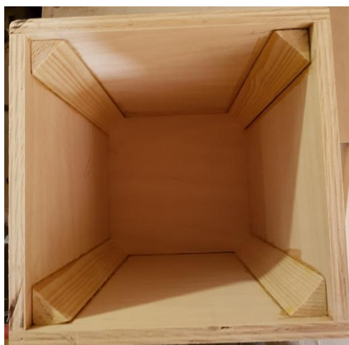
Slika 15: Notranjost boka po tem, ko se je lepilo posušilo, (Vir: lasten)
