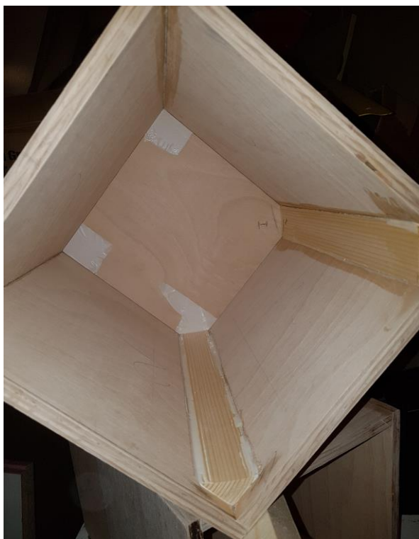
Slika 13: Prilepljena boks, (Vir: lasten)
