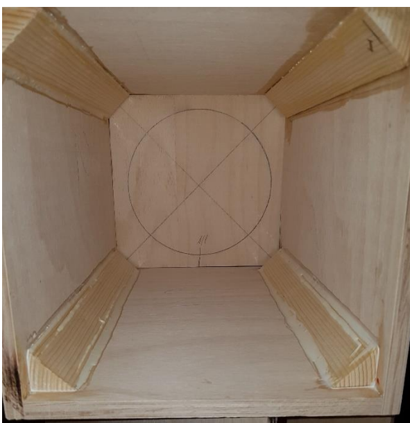
Slika 14: Označba za izrez odprtine za zvočnik, (Vir: lasten)
