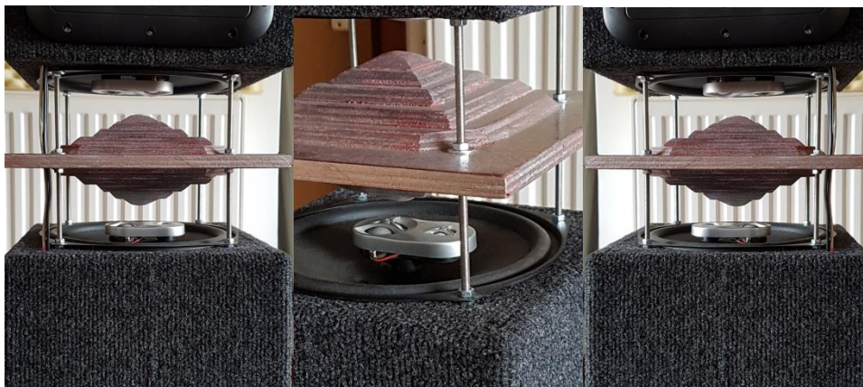
Slika 22: Zvočnik v boksu z improviziranim stožcem, (Vir: lasten)
