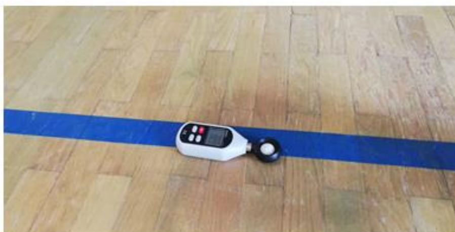
Slika 14: Merjenje osvetljenosti z luksmetrom (Foto: U. Sušec).
