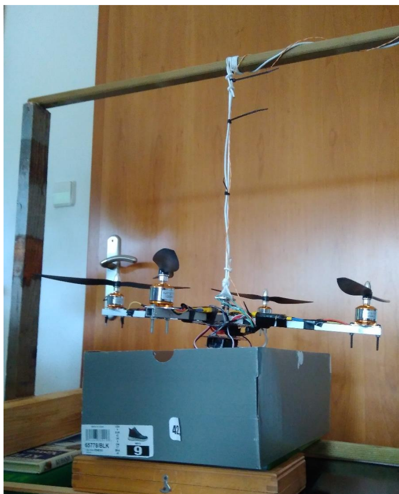
Slika 19: Dron med kalibracijo PID-zanke
