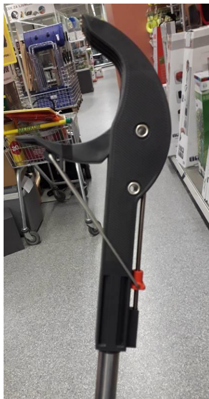
Slika 25: Mehanizem na palici za pobiranje smeti in listja (Foto: B. Ranzinger).
