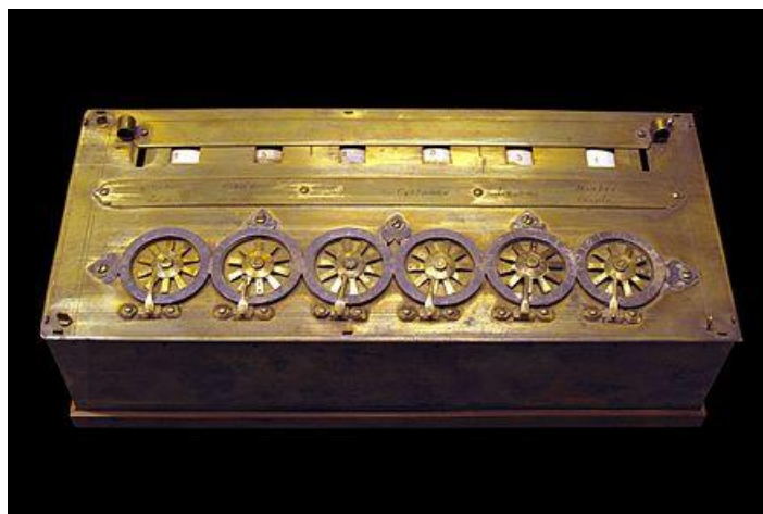
Slika 5: Pascalovo mehansko računalo [5].
