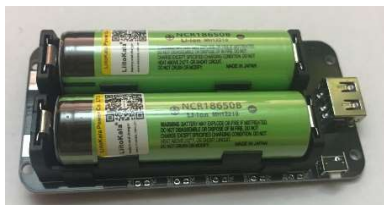
Slika 19: Akumulator z baterijama tipa 18650 (Vir: lasten)
