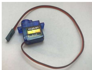
Slika 18: Mikro servomotor SG90 (Vir: lasten)
