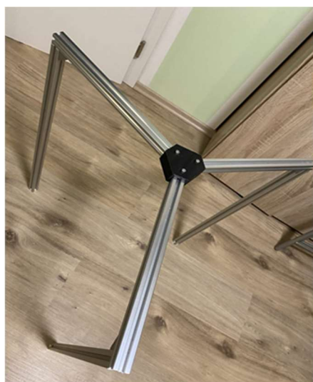
Slika 34 Stojalo robota, izdelano iz AL profilov
