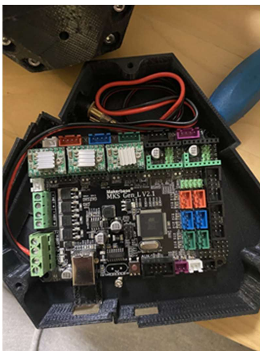
Slika 32: Arduino krmilnik MKS GEN LV 2.1 v ohišju
