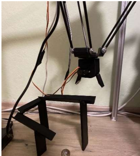
Slika 28: Prijemalo, montirano na robota, in servo motor za prijemalo MG90S
