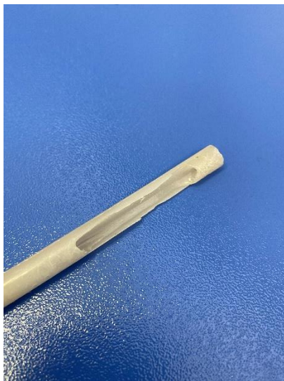
Slika 24: Slaba zapolnjenost palice (Vir: lasten )
