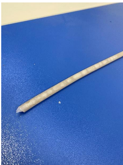
Slika 25: Slaba kakovost površine palice (Vir: lasten )
