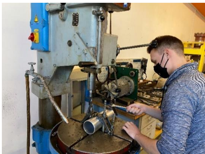
Slika 10: Priprava na vrtanje luknje v cilinder cilinder
