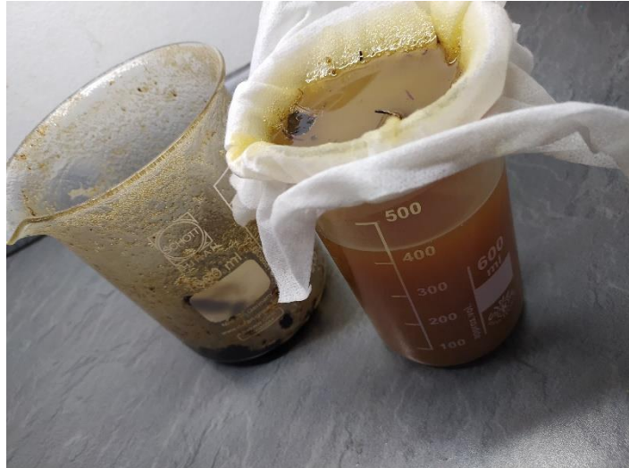
Slika 4: Slika 4: Filtriranje smole (Foto: K. Lorenčič).
