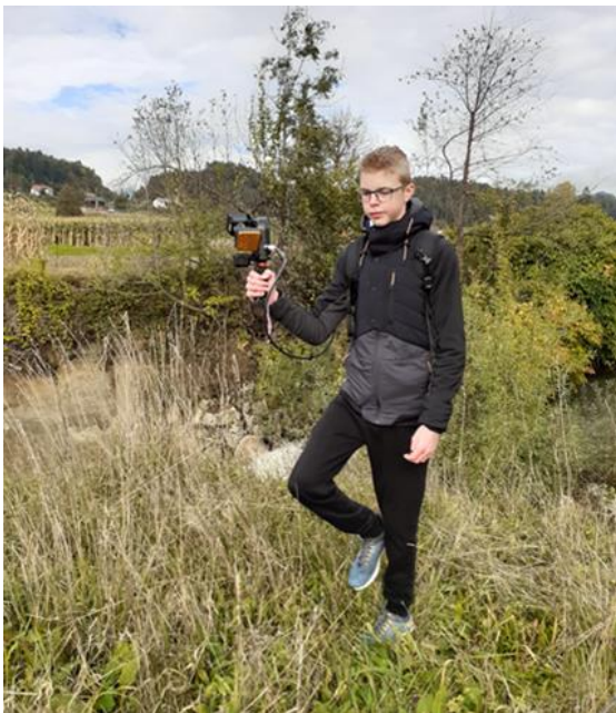
Slika 30: Merjenje s 3D skenerjem (Foto: B. Mestnik) in desno mobilni 3D laserski skener (Foto: I. Preložnik)
