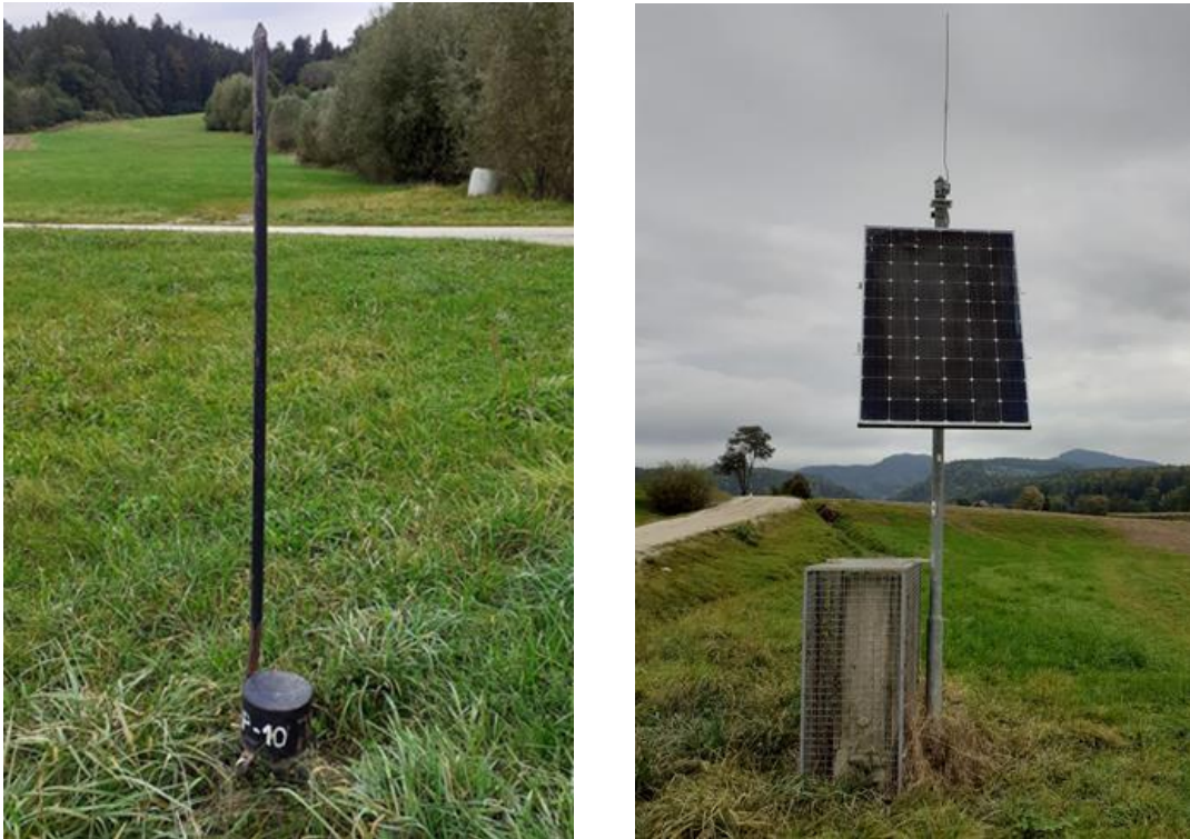
Slika 26: Piezometer (levo) (Foto: U. Raško), Seizmograf (desno) (Foto: I. Preložnik)
