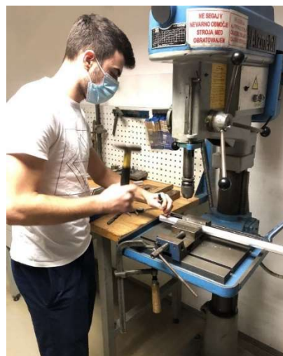
Slika 22: Izdelava nosilne noge teleskopskega ogrodja.
