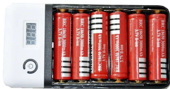
Slika 16: Napajalnik z vgrajenimi baterijami tipa 18650.
