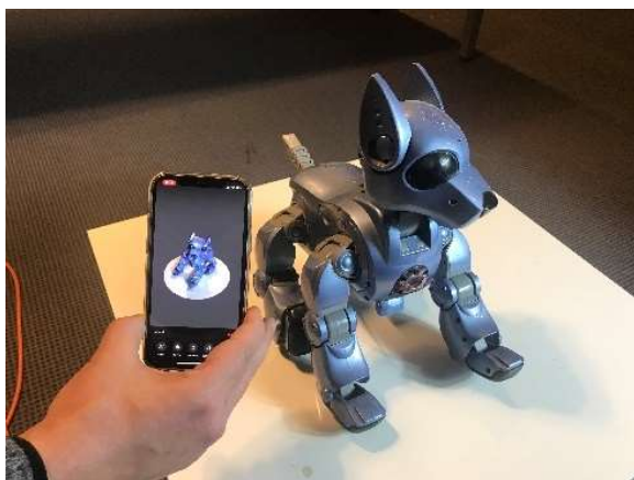
Slika 8: 3D sken, izdelan s pomočjo mobilnega telefona iPhone 12 Pro.
