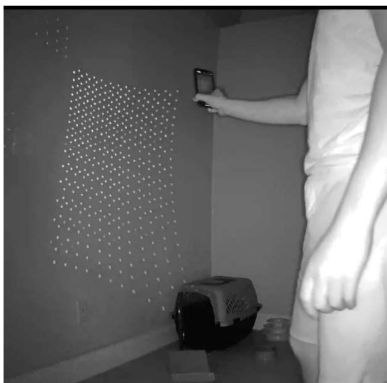
Slika 49: Mreža laserskih žarkov (Iphone LIDAR skeniranje, posneto z IR kamero). ( https://i.imgur.com/7o01Bwa.jpg )
