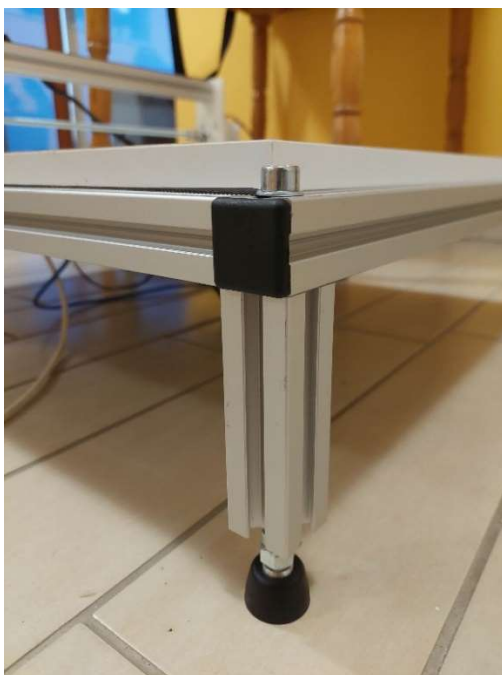
Slika 17: Kapa za ALU profil ter konstrukcija podpornih nog
