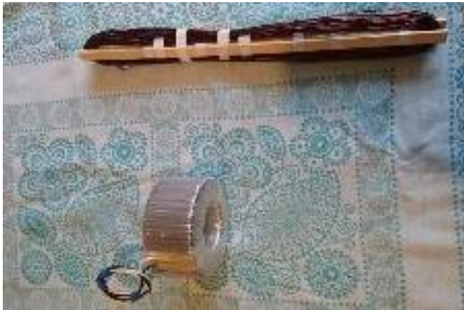
Slika 73: Transformator z odvitim sekundarjem
