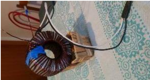
Slika 75: Končano navijanje sekundarja
