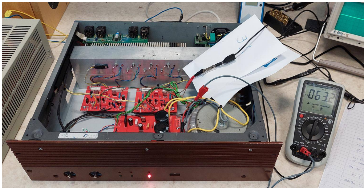
Slika 89: Meritev mirovnega toka mojega ojačevalnika
