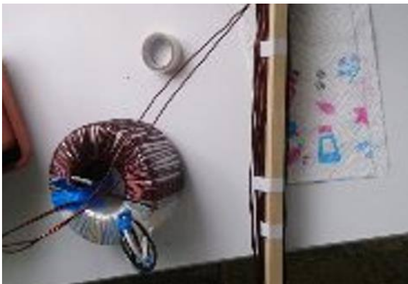
Slika 74: Napol navit sekundar
