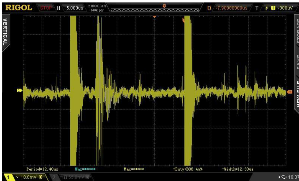
Slika 90: Meritev napetosti šuma mojega ojačevalnika
