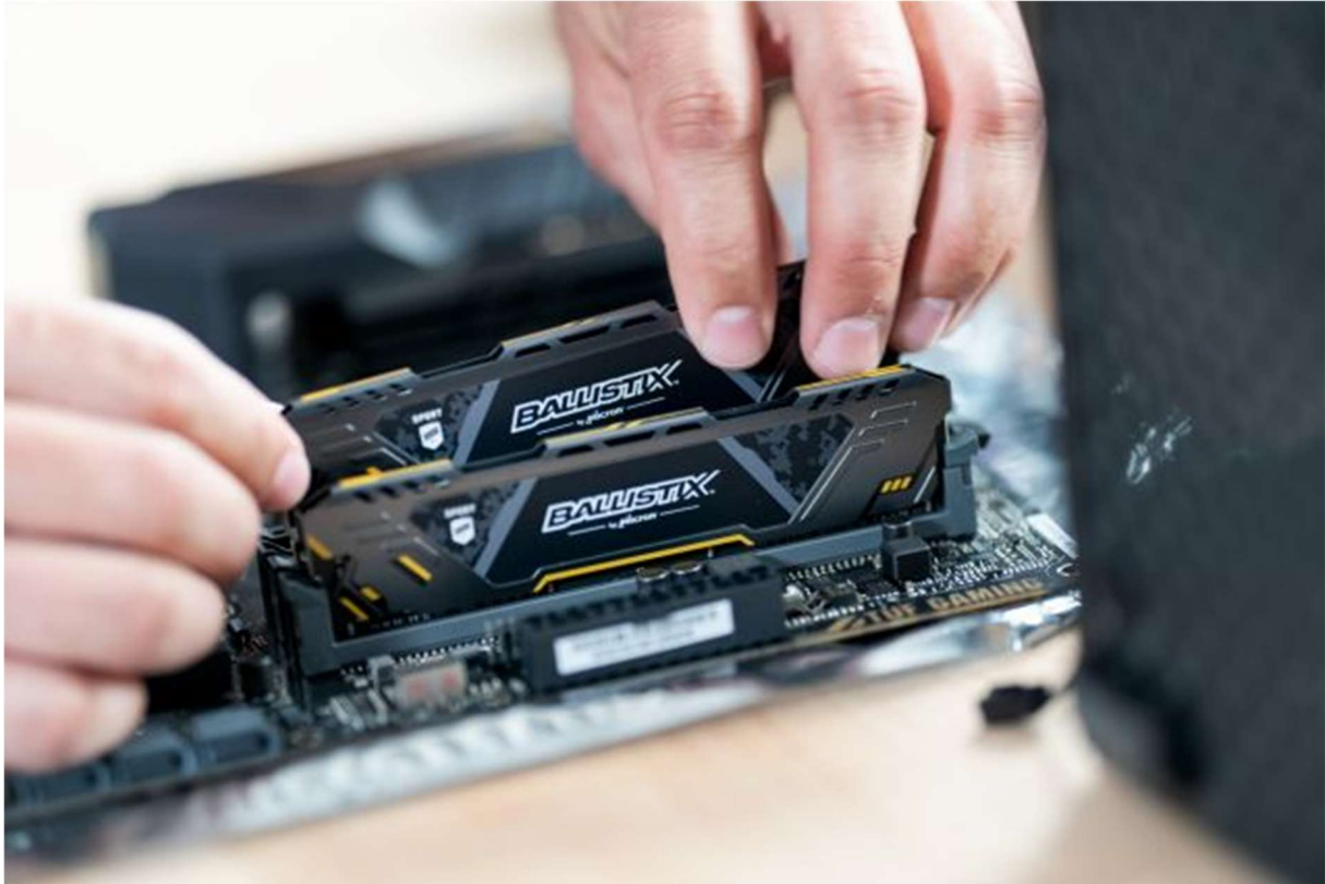
Slika 12: Vgradnja RAM pomnilnika.
