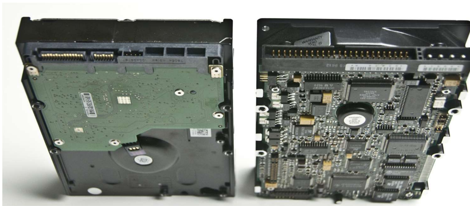
Slika 7: Sata (levo) in IDE (desno) vodilo.
