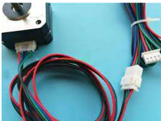
Slika 45: Podaljšek za kabel za povezavo koračnega motorja s krmilnikom
