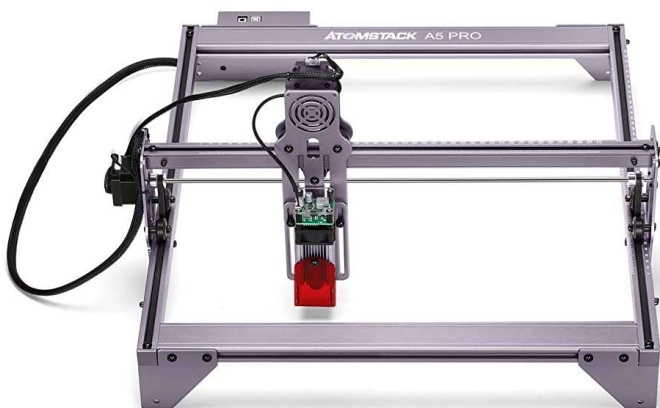
Slika 10: Kinematika kartezijskega laserja
