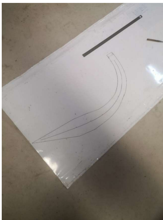
Slika 26: Izrisovanje oblike resonančnega izpuha (vir: lastni)
