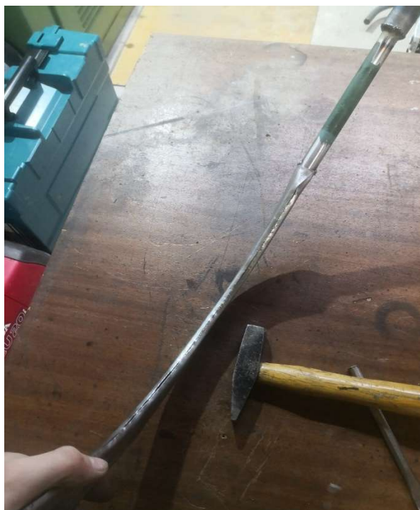
Slika 28: Varjenje dveh polovic resonančnega izpuha (vir: lastni)
