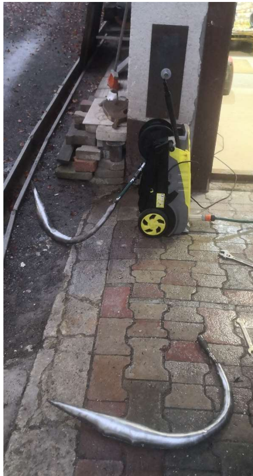
Slika 30: Oblikovanje resonančnega izpuha z vodo pod tlakom (vir: lastni)
