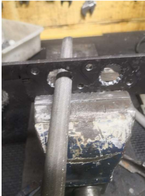
Slika 22: Izdelava prirobnic (vir: lastni)
