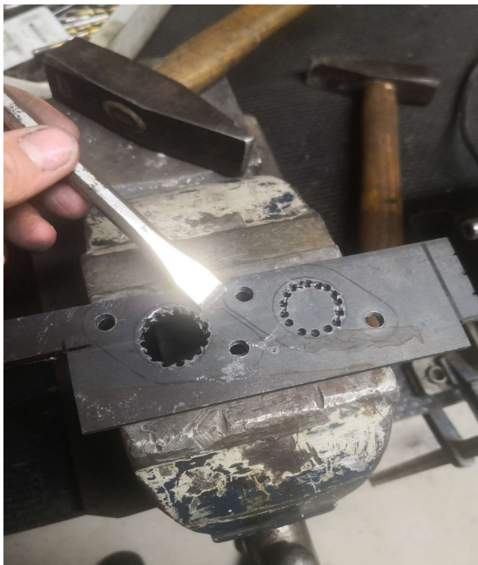
Slika 21: Izdelava prirobnic (vir: lastni)
