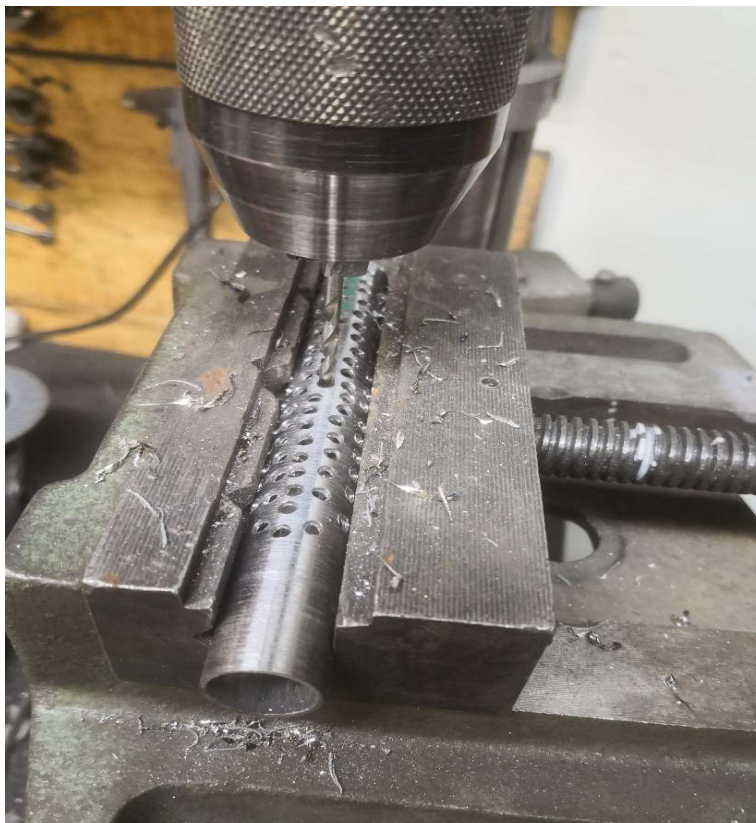
Slika 31: Izdelovanje izpušne cevi resonančnega izpuha (vir: lastni)
