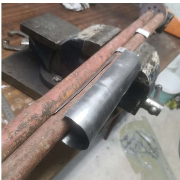
Slika 32: Izdelovanje zunanjšega plašča dušilca (vir: lastni)
