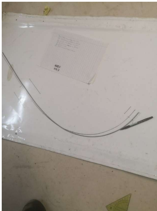
Slika 25: Zarisovanje oblike resonančnega izpuha (vir: lastni)
