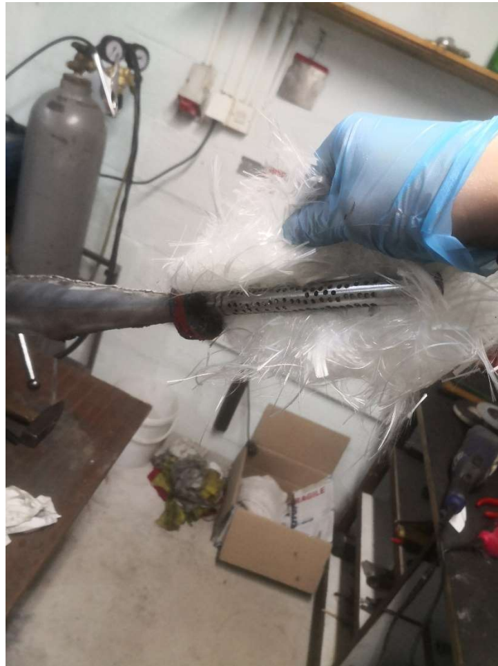
Slika 34: Namestitev dušilca na resonančen izpuh (vir: lastni)
