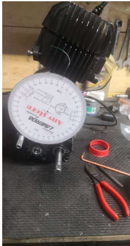
Slika 12: Merjenje stopinj odprtega izpušnega kanala (vir: lastni)
