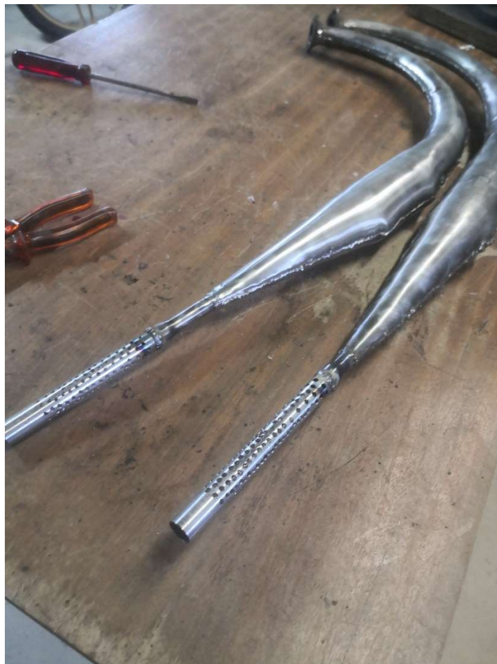
Slika 33: Prileganje izpuha na motocikel (vir: lastni)
