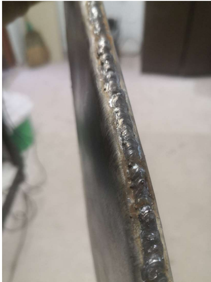
Slika 29: Varjenje polovic resonančnega izpuha (vir: lastni)
