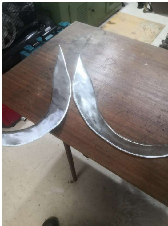
Slika 27: Izrezane in očiščene obe polovice resonančnega izpuha (vir: lastni)
