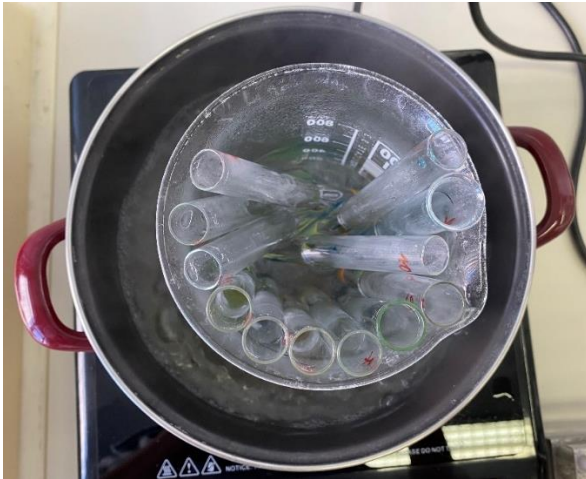
Slika 10: Čaša z epruvetami v vroči vodni kopeli na električnem kuhalniku (foto: A. Marinčič Barić)
