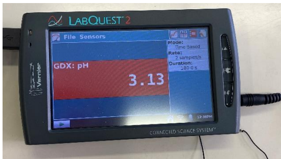
Slika 16: Naprava, priključena k pH-senzorju, ki je izpisala vrednost pH
