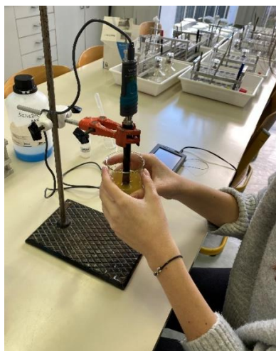
Slika 15: Sonda pH-merilnika v čaši s sladko pijačo (foto: I. Štimac)
