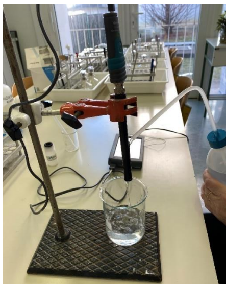
Slika 17: Spiranje sonde senzorja s pomočjo puhalke, napolnjene z vodo (foto: I. Štimac)
