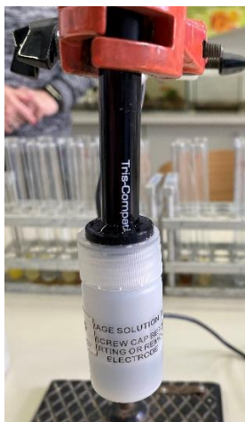
Slika 18: Sonda pH-senzorja, potopljena v steklenički raztopine kalijevega klorida (foto: A. Marinčič Barić)
