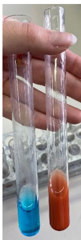
Slika 22: Primerjava obarvanosti oborine v kontrolnem testu (levo) in epruveti, ki je vsebovala raztopino čiste glukoze – pozitivni kontrolni test (foto: A. Marinčič Barić)
