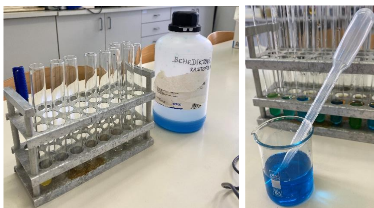
Slika 8: Stojalo s pripravljenimi epruvetami in alkoholnim flomastrom (levo) in benediktova raztopina v čaši s pipeto (desno), (foto: A. Marinčič Barić)
