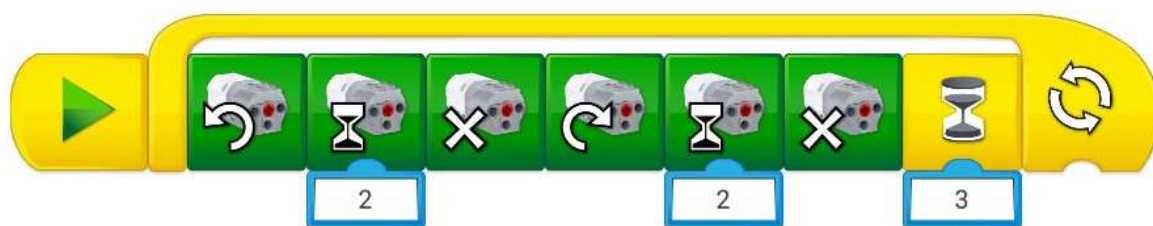
Slika 8: Algoritem programa časovno nastavljene zapornice.
