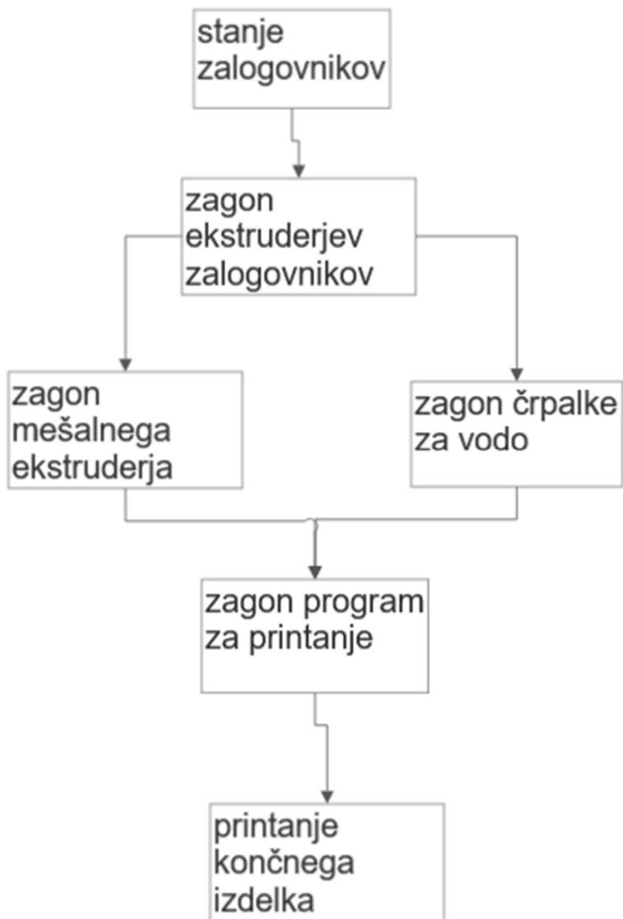
Slika 11 blokovna shema delovanja
