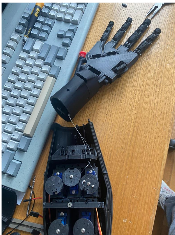
Slika 4: prikazuje nameščene motorčke v notranji del roke. (Vir: lasten)
