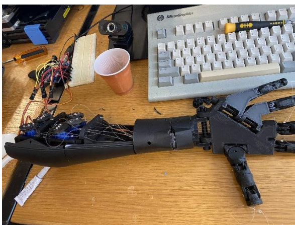
Slika 8: Prikazuje povezavo arduina z sestavljeno roko.
