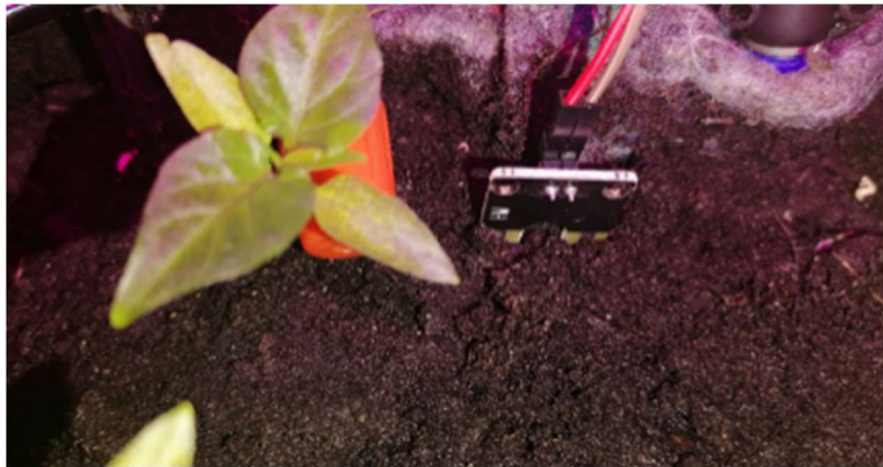
Slika 44: Senzor merjenja vlage zemlje (Foto: K. Muha).
