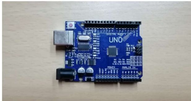
Slika 35: Arduino UNO (Foto: K. Muha).
