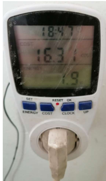
Slika 25: Merilec porabe električne energije z vtičnico (Foto: K. Muha).
