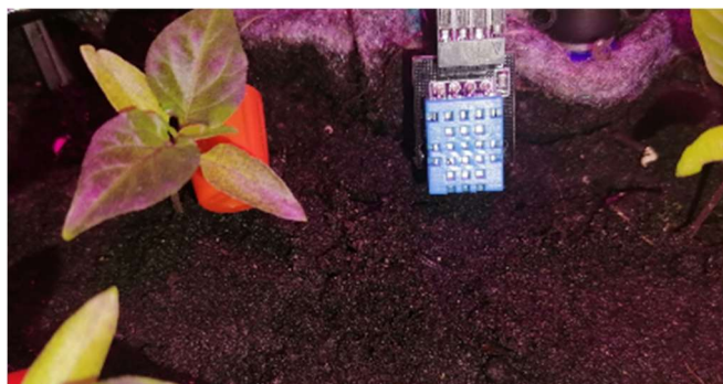
Slika 43: Senzor temperature in vlage DHT11 (foto: K. Muha).
