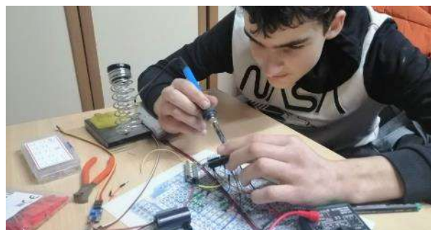
Slika 22: Spajkanje na razširitevno ploščo (foto: K. Muha).
