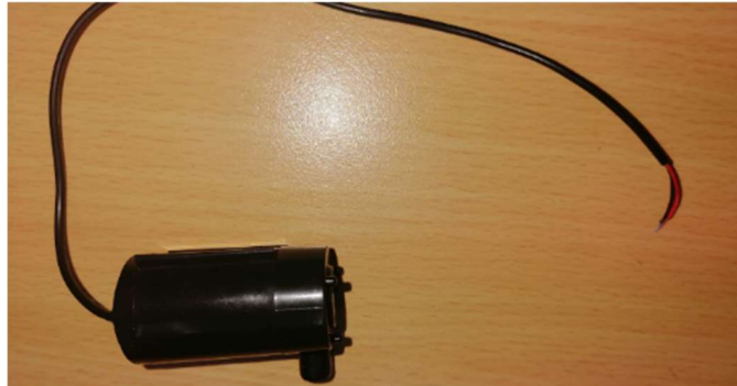
Slika 32: Mikro potopna črpalka za vodo (Foto: K. Muha).
