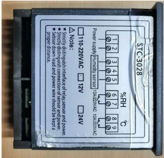
Slika 31: STC-3028 - Dvojni digitalni termostat (foto: K. Muha).
