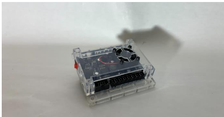
Slika 6: CNCTOPBAOS 3 Axis GRBL kontrolna plošča za DIY CNC stroj
