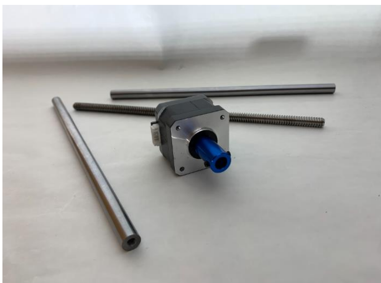
Slika 4: Koračni motor Nema 17 uporabljen za izgradnjo DIY CNC stroja
