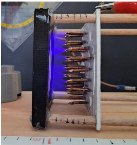
Slika 26: Iskrenje med elektrodama v optimalnem položaju
