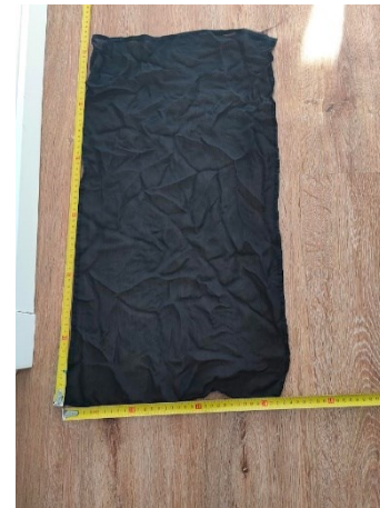
Slika 14: Velikost in zmečkanost tencela.
