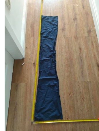
Slika 16: Velikost in zmečkanost materiala iz ekobombaža.
