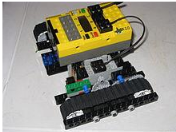
Slika 3: Primer robota na osnovi LEGO RCX.
