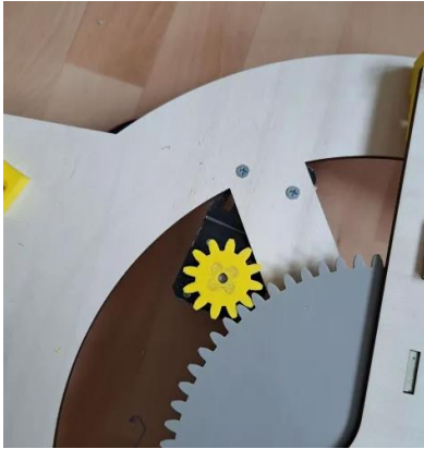
Slika 73 Pritrditev motorja na ploščad (foto: T.Mustač)
