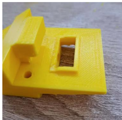
Slika 71 Dodatna obdelava z olfa nožem (foto: T.Mustač)
