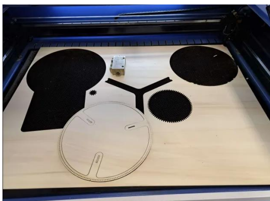
Slika 66 Rezanje kosov na laserskem stroju (foto: T.Mustač)
