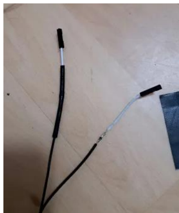
Slika 70 Izdelava povezovalnih žičk (foto: T.Mustač)
