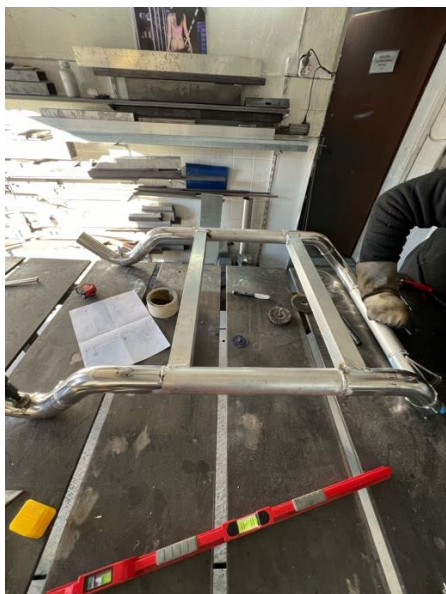
Slika 2 Osnovno ogrodje simulatorja
