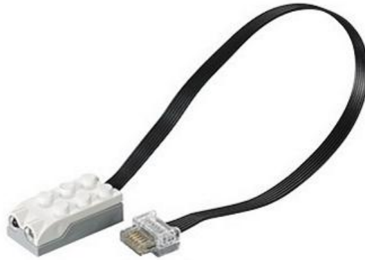
Slika 9: Senzor premikanja LEGO WE DO 2.0.
