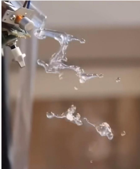
Slika 2: Višja frekvenca zvoka ter oblika vodnega curka
