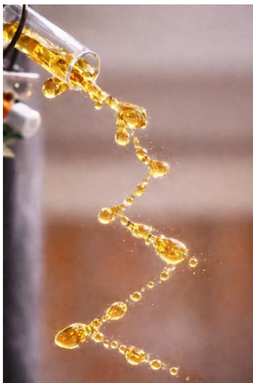
Slika 4: Višja frekvenca zvoka in oblika oljnega curka
