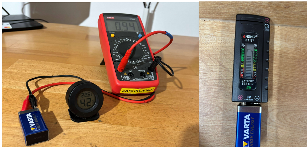
Slika 7: Meritev in preverjanje napetosti baterije (Lasten vir)
