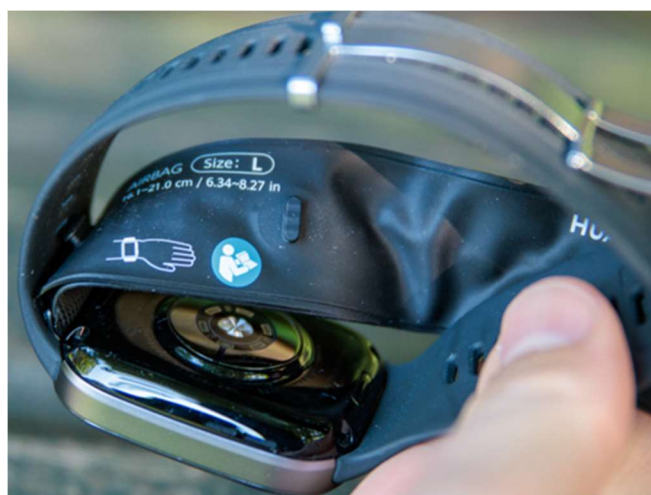
Slika 26: Vgrajena manšeta na Huawei Watch D
