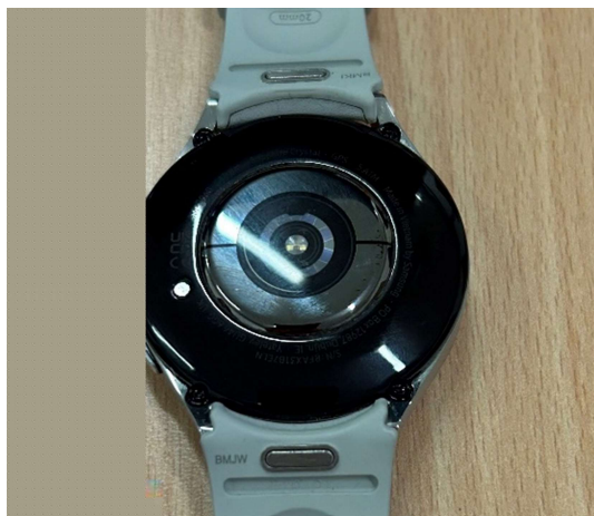
Slika 16: PPG senzor na pametni uri, ki smo jo uporabili za meritve
